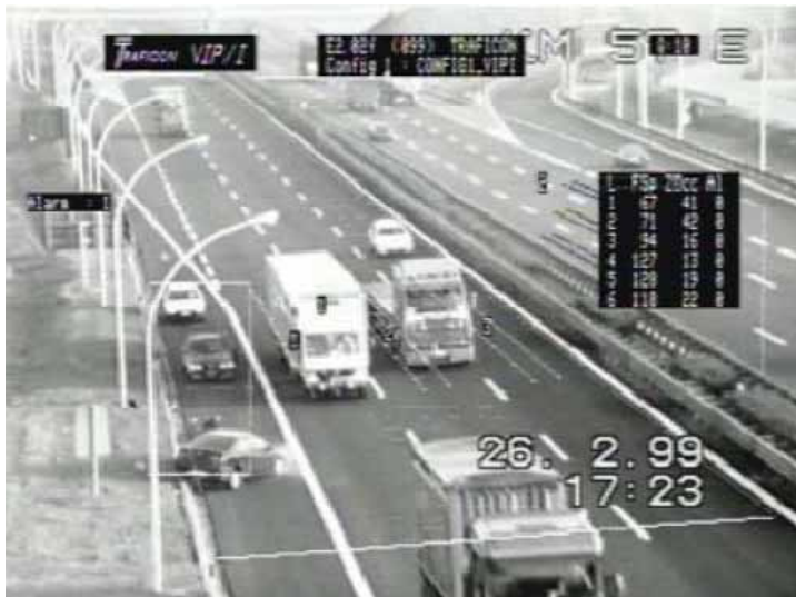
Figuur 29 Incidentdetectie (Traficon AID)
