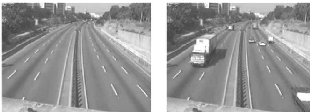
Figuur 25 Background modelling, links achtergrond beeld en rechts het totaalbeeld (Hsieh, et al. 2006)
